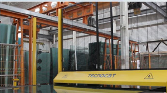
Máquinas de movimiento lineal accionadas por motor con precisión de  $\pm 0,2$  mm. sistemas de corte automático de tecnología europea.
